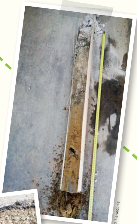
Carottes extraites du sol en place.
