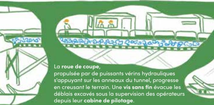
La **roue de coupe**, propulsée par de puissants vérins hydrauliques s'appuyant sur les anneaux du tunnel, progresse en creusant le terrain. Une **vis sans fin** évacue les déblais excavés sous la supervision des opérateurs depuis leur cabine de pilotage.
