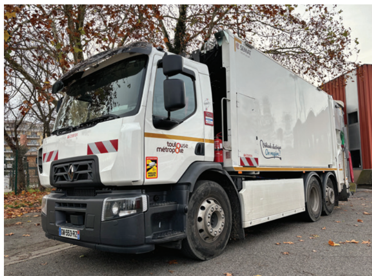
Benne de collecte des ordures ménagères électrique
