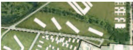
. Pour l'îlot O, le choix d'une disposition en «peigne» d'orientation générale Nord-Ouest Sud-Est, et pour des bâtiments acceptant le cas échéant des parkings semi-enterrés utilisant la pente ;
