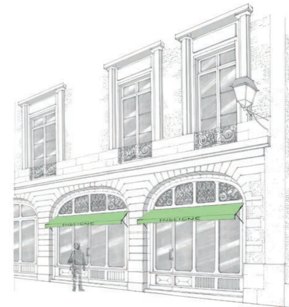
Les bras des stores* sont fins et peuvent être ouvragés. Ils sont fixés sur la menuiserie de la devanture*.
