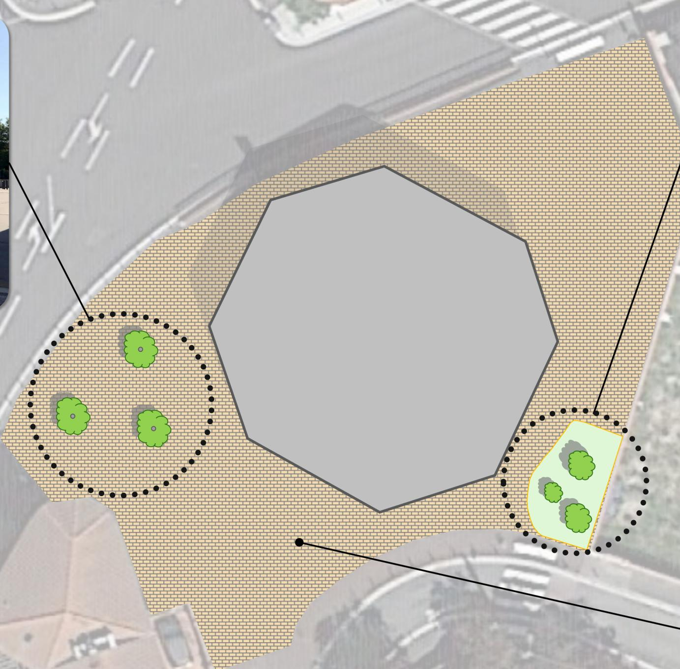
Expérimentation d'un revêtement en résine, aspect pavé, permettant de réduire la température jusqu'à 3°C en période de fortes chaleurs.
