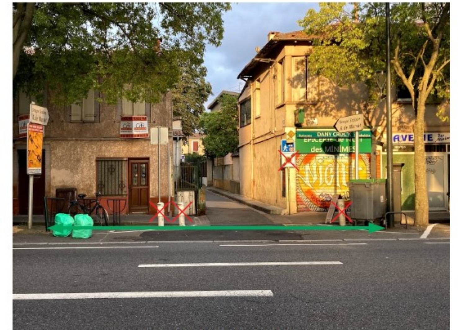
Suppression des 3 balisettes Pose de potelets (tous les 1,5m) Suppression du panneau « sortie de zone à stationnement payant »
