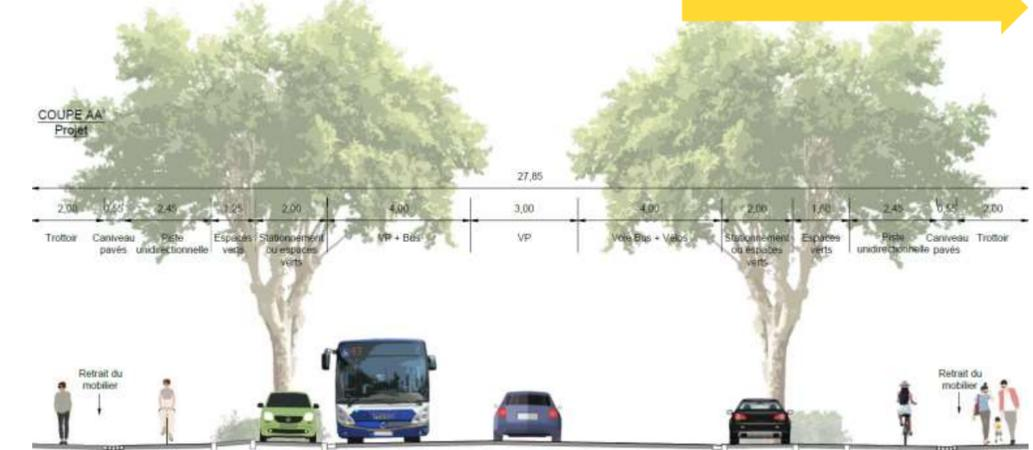
Piste cyclable unidirectionnelle dans la contre allée côté pair et bandes cyclables sur la chaussée côté impair
