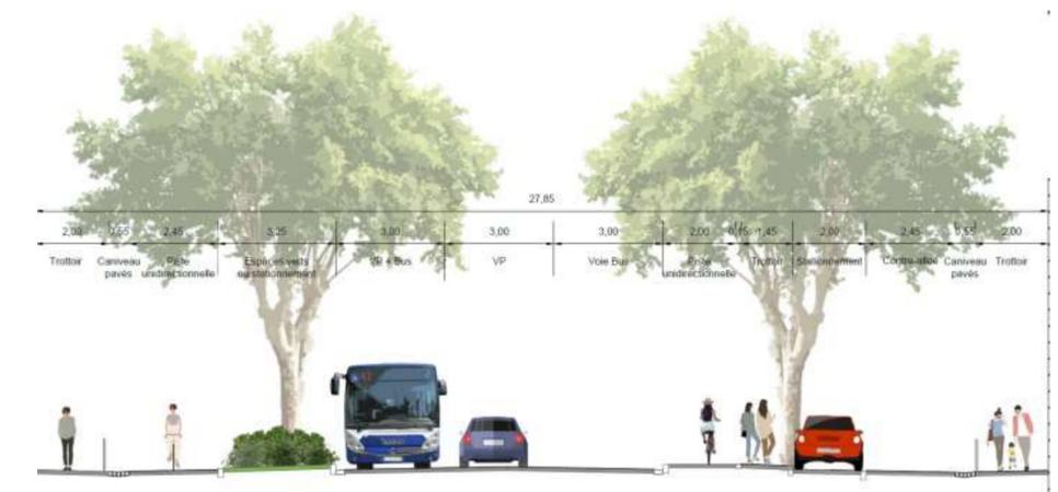
Maintien en l'état : bandes cyclables sur chaussée côté impair et voie cyclable sur couloir bus côté pair
