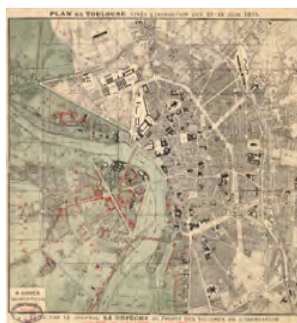
› Carte de la crue de 1875. En bleu, la partie submergée. En rouge, les maisons effondrées
